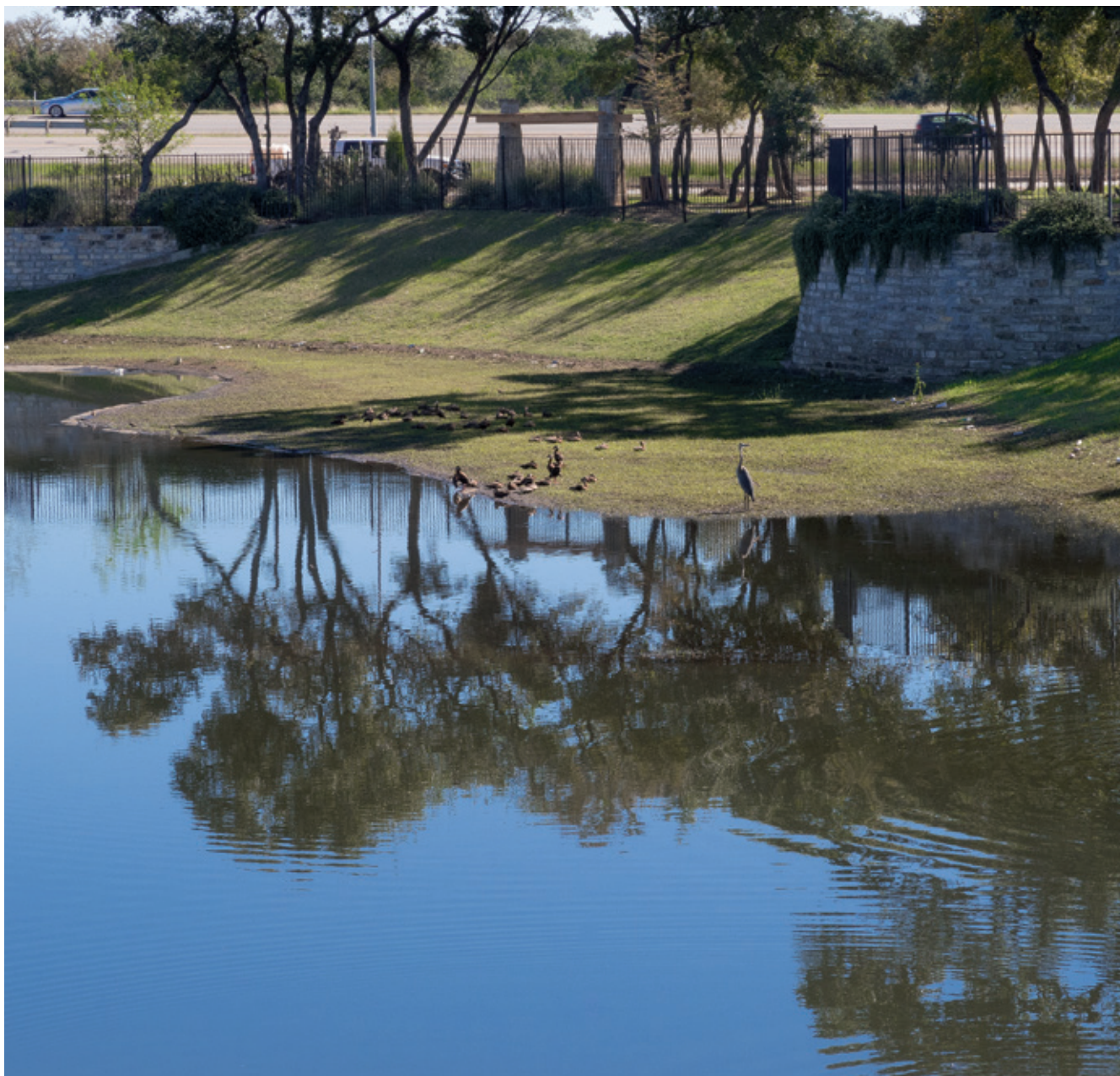
Figura 46. Esempio di bacino di detenzione per lo stoccaggio delle acque di pioggia a seguito di eventi meteorici di forte intensità.
